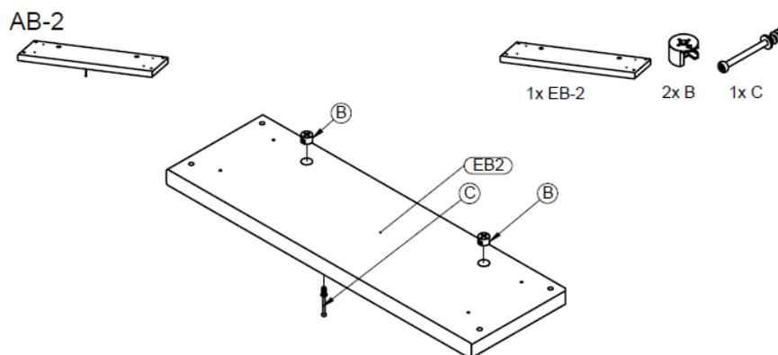
**Stap 2 :** Gebruik de bodemplaat **EB2**, één verbindingbout **C** en twee excentrieken **B**
