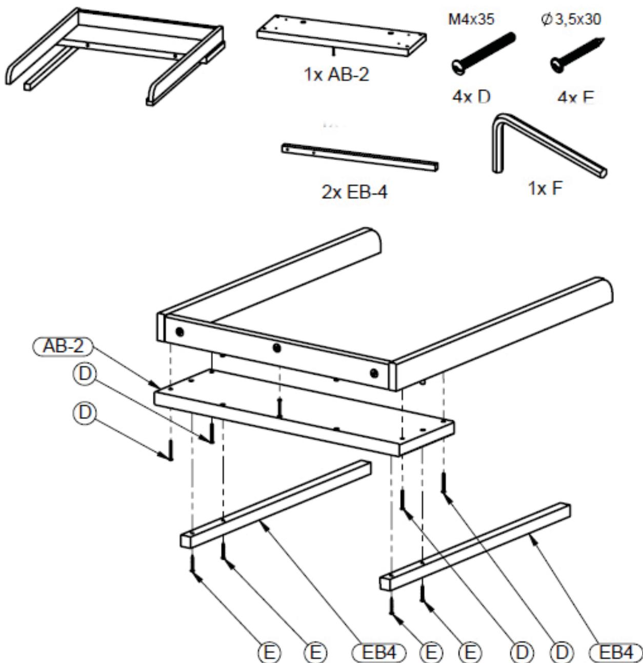
**Schritt 5 :** Benutzen Sie die Bauteile von Schritt 4, den Boden **AB2**, beide Stützträger **EB4**, vier Holzschrauben **D** und vier Holzschrauben **E**
