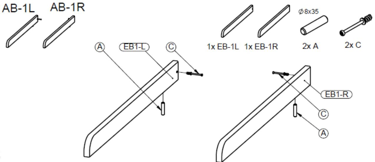
**Schritt 1 :** Benutzen Sie beide Seiten EP1 (L und R), zwei Holzdübel A und zwei Verbindungsbolzen C
