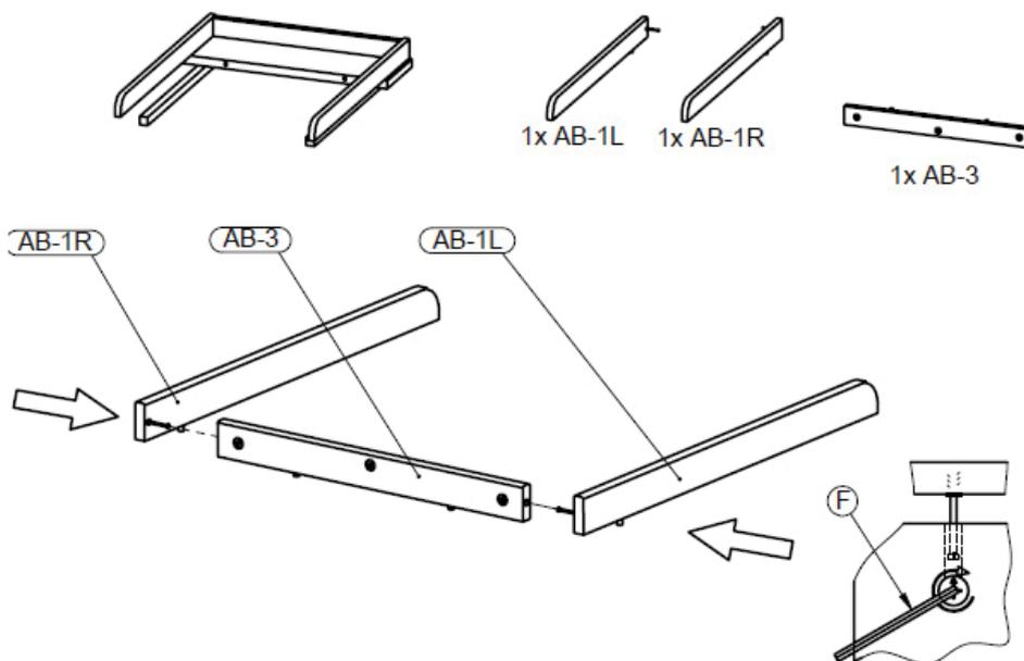
**Schritt 4 :** Benutzen Sie die zusammengebauten Teilen **AB1 (L und R)** und **AB3**
