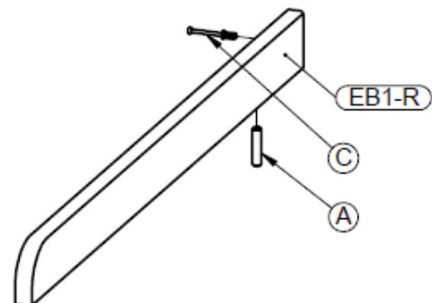
**Etape 1 :** Utilisez les deux côtés **EB1 (L et R)**, deux chevilles en bois **A** et deux boulons de raccord **C**
