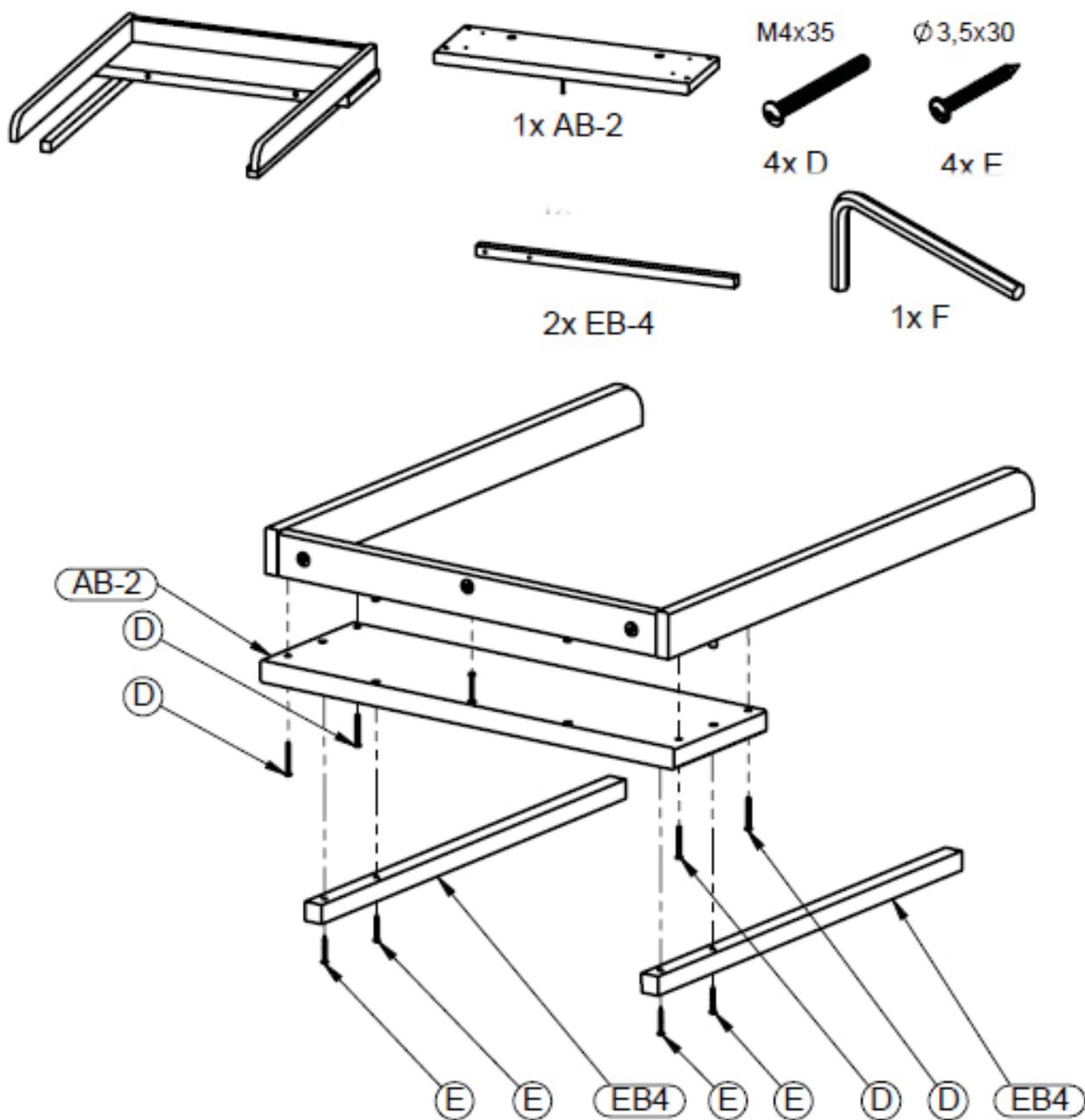
**Etape 5 :** Utilisez les pièces de l'étape 4, le fond **AB2**, les deux lattes de support **EB4**, quatre vis à bois **D** et quatre vis à bois **E**
