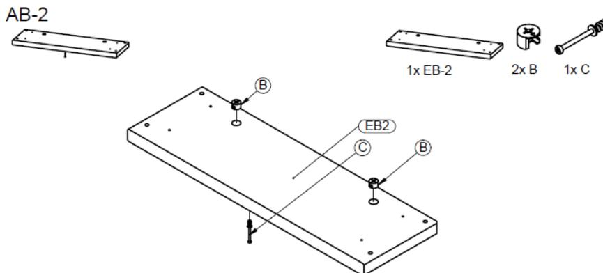
**Schritt 2 :** Benutzen Sie die Bodenplatte **EB2**, ein Verbindungsbolze **C** und zwei Exzenter **B**
