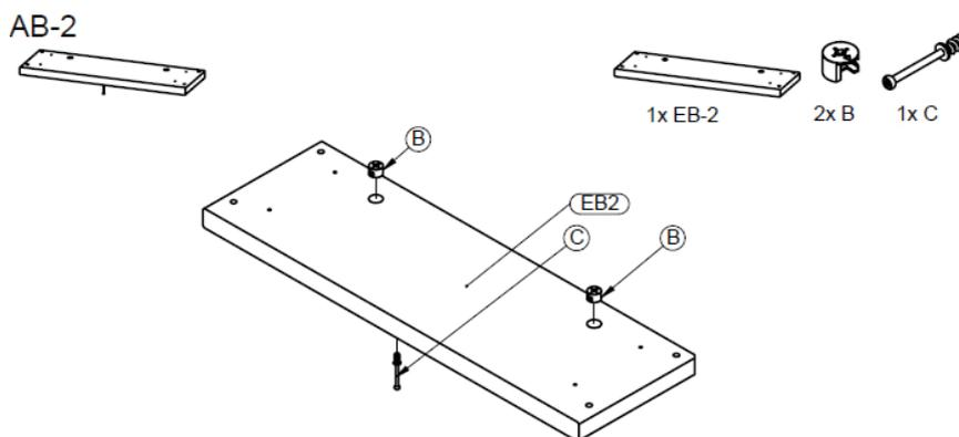
**Etape 2 :** Utilisez le fond **EB2**, un boulon de raccord **C** et deux excentriques **B**
