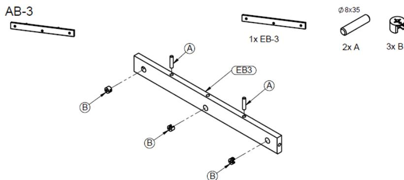
**Schritt 3 :** Benutzen Sie die Rückseite **EB3**, zwei Holzdübel **A** und drei Exzenter **B**
